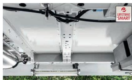
» Lifetime-Smart: construcción del suelo a prueba de corrosiones, sin costillaje de madera con revestimiento exterior de GFK
