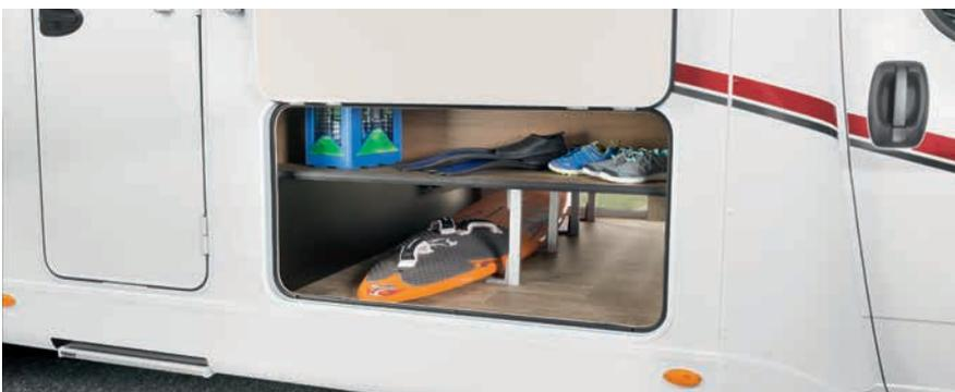
» A 7877-2: doble plancher, en parte con capacidad de carga en todo el ancho del vehículo y ubicación perfecta para depósitos de agua, tuberías y cableado protegido contra daños y bajas temperaturas.
